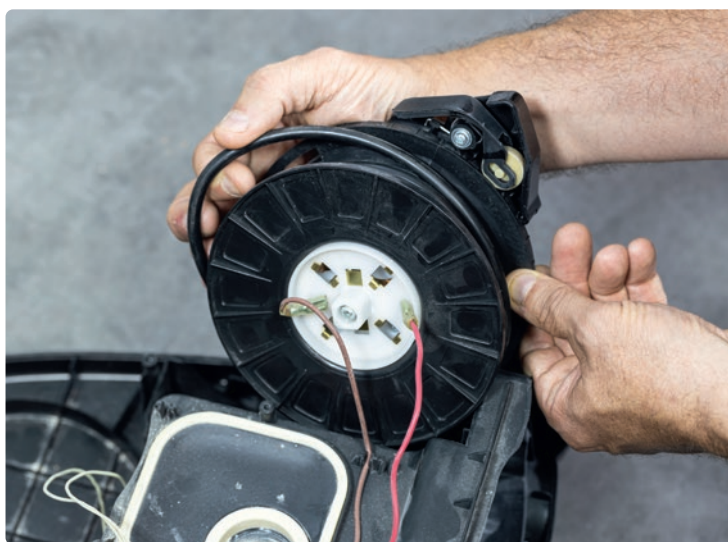
Le mécanisme de l'enrouleur est très reconnaissable et se situe en général sous le capot.
