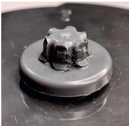
On voit clairement sur cette photo que l'élément de couplage entre le corps du blender et le bol est usé.
